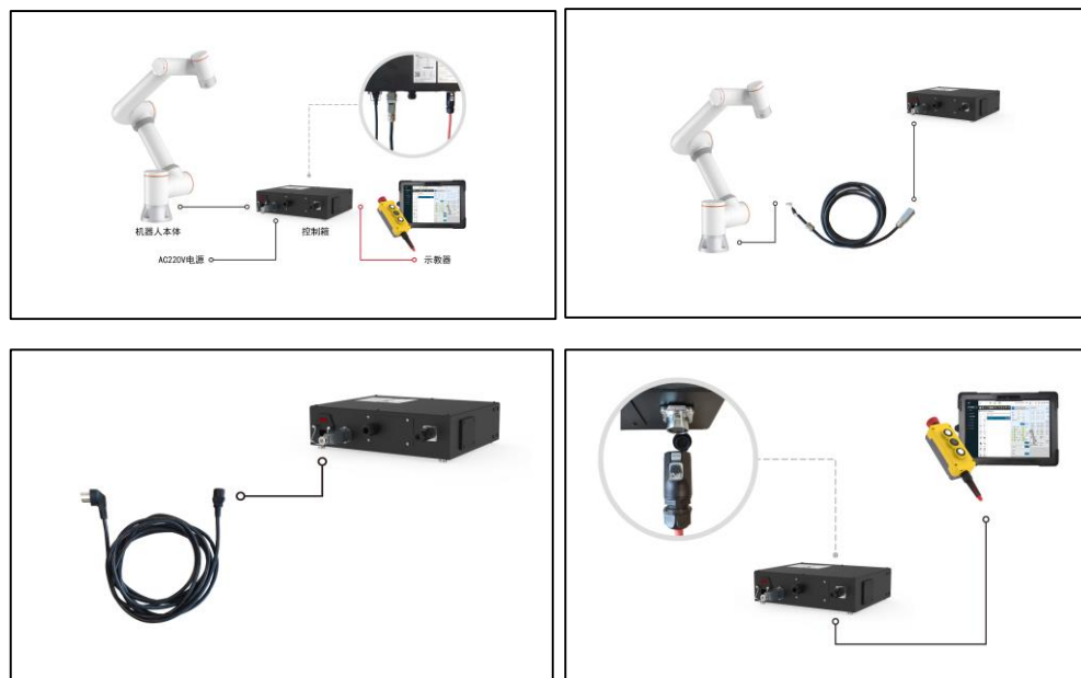
图表 1.6-1 控制箱接线面板
